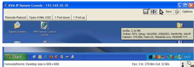
Die Kommandos in der Kontrolleiste oben links sind bis auf den Remote Reboot Button (löst remote ein CTRL-ALT-DELETE aus) konfigurierbar. Mit den Buttons rechts in dieser Leiste können Sie Einstellungen für die
